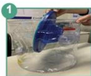
1 Introduza de forma inclinada o conjunto membrana de silicone / anel interno no interior da cápsula de PVC conforme foto.
