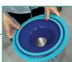
3 Usando uma das mãos segure o conjunto membrana de silicone / anel interno e com a outra passe o anel externo a partir da base inferior da cápsula de PVC subindo-o até o encontro com conjunto membrana de silicone / anel interno. Após esse instante passe o conjunto membrana de silicone / anel interno sobre a a borda da cápsula de PVC até que as partes esteja completamente alinhadas e sem desníveis entre as partes conforme foto.
